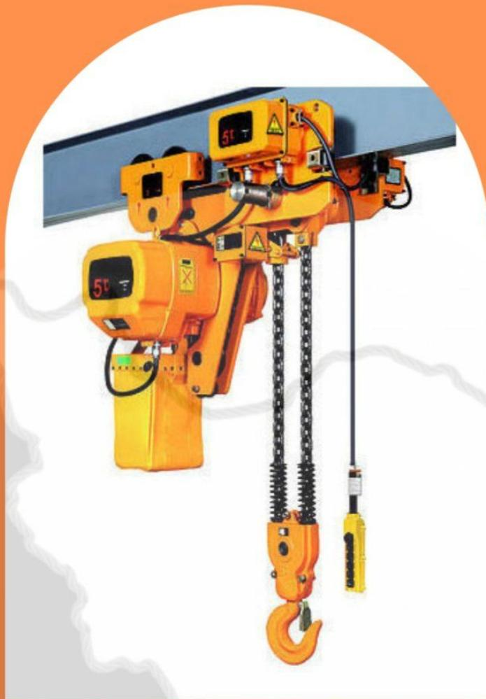
جرثقیل های برقی 4 کاره بر عکس جرثقیل برقی 2 کاره از طریق قلاب مستقیما به سقف اتصال پیدا نمی کنند بلکه در بر لای اتصال آنها یک ترولی قرار گرفته است که بر روی ریل هایی که بر روی سقف تعییه شده اند قرار گرفته و با حرکت بر روی ریل قابلیت انتقال بار در جهت افق را نیز بوجود می آورد. جرثقیل برقی 4 کاره به سبب استفاده از ترولی که معمولاً ظرفیت آن حداقل برابر با ظرفیت باری جرثقیل برقی و یا بالاتر انتخاب میشود قیمت بالاتری دارد.
