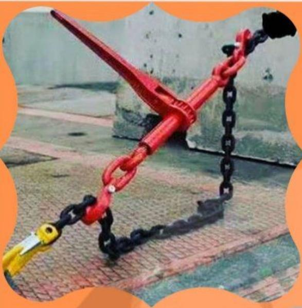
چرخش دنده های موجود در این ابزار، اگر در جهت چرخش عقربه های ساعت باشد، باعث آزاد کردن دانه های زنجیر بار می شود. این ابزار در سایزهای 1/4 - 5/16 تا 1/2 - 5/8 موجود است. این سایزهای برای استفاده همراه با زنجیرهایی از سایز 6 میلی متر تا 16 میلی متر می باشد. از بهترین برندهای تولید کننده این ابزار می توان به برند کارل اشتال آلمان اشاره کرد. این برند در تولید جکوی از فولاد گرید 80 استفاده می کند
