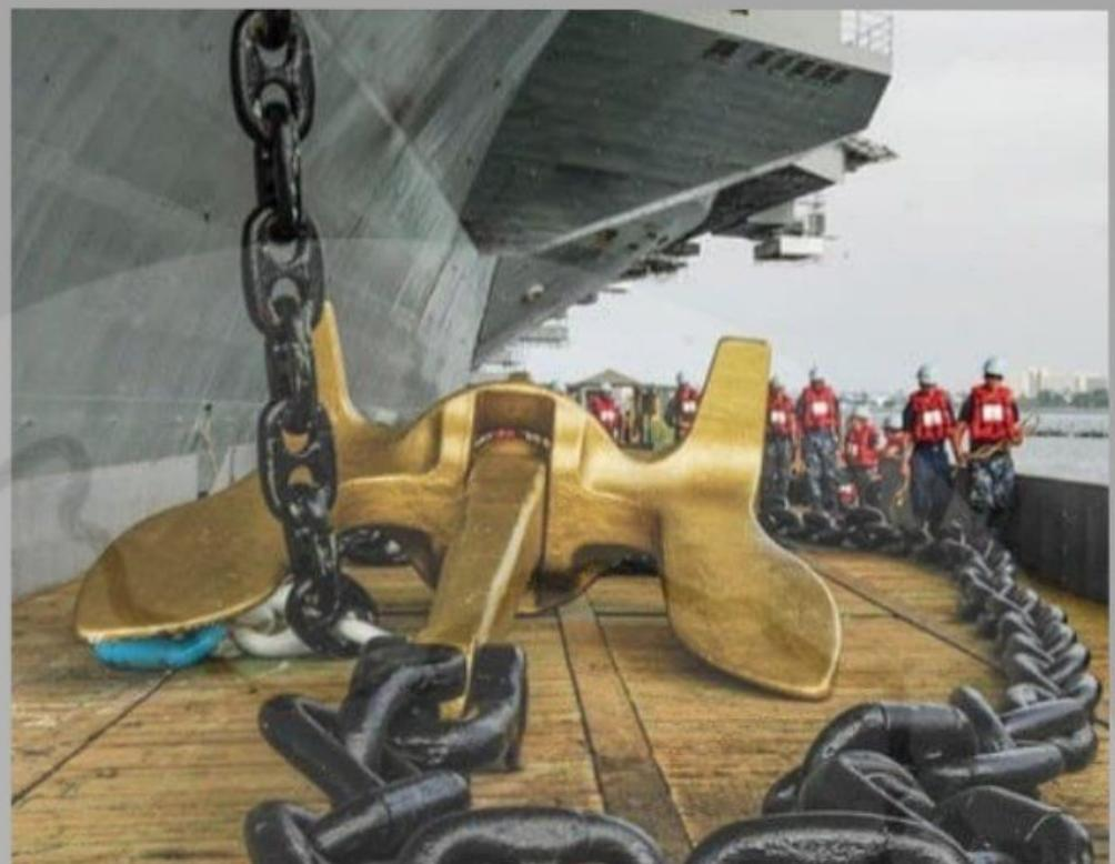
زنجیر لنگری بدون پله ای به شکلی است که دانه های زنجیر آن دارای طول داخلی بزرگتری از زنجیرهای دیگر میباشد و با سه نوع گرید U1، U2، U3 تولید و ارائه میگردد که گرید U3 دارای استحکام بالاتری از گریدهای دیگر میباشد البته زنجیر لنگری از نوع پله ای دارای استحکام بالاتری نسبت به زنجیر لنگری بدون پله ای میباشد. زنجیر لنگر پله ای برای کشتیرانی ها جهت لنگراندمازی کشتنی توسط وینچ به دریا استفاده میشود. (البته برای مهار تورهای قفس های پرورش ماهی در دریا نیز استفاده میشود.)
