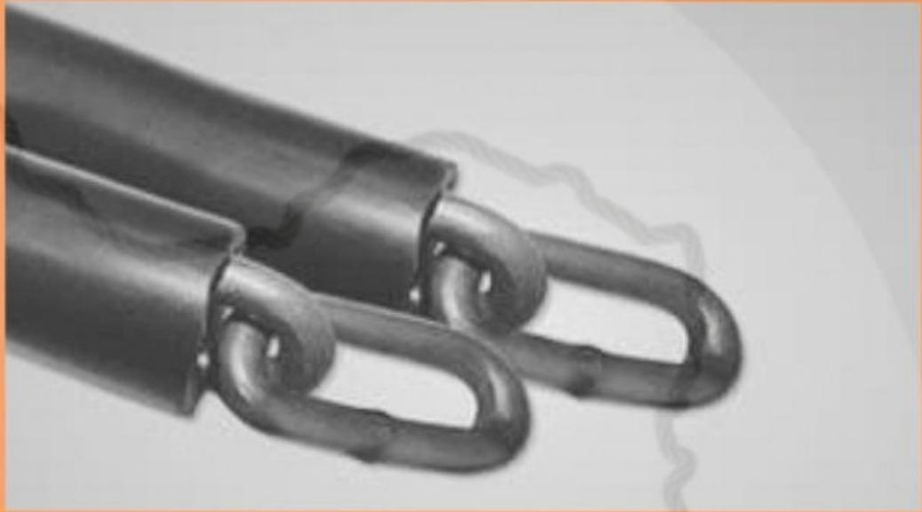
زنجیر جبران آسانسور از یک سمت به زیر کابین آسانسور و از سمت دیگر به زیر قاب وزنه تعادل آسانسور متصل می‌شود. این اتصال باید به گونه‌ای باشد که در زمان حضور کابین در بالاترین متر از طبقات و قرار گرفتن وزنه تعادل در پایین نقطه ممکن در چاه آسانسور، تعادل وزن سیستم آسانسور برقرار شود. در هنگام حرکت آسانسور ممکن است حرکت زنجیر جبران آسانسور باعث ایجاد سر و صدا و آلودگی صوتی شود. برای از بین بردن این عیب بزرگ، از زنجیر جبران‌های دارای روکش پلاستیکی استفاده می‌شود.
