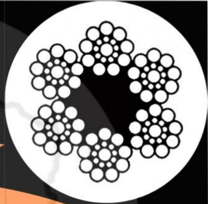
سیم بکسل 6\*19 با مغزی کنف و بافت سیل از 6 حلقه سیم که به دور یک هسته کنفی پیچیده شده تشکیل گردیده است که درون هر کدام از این حلقه ها 19 رشته مفتول قرار گرفته است
