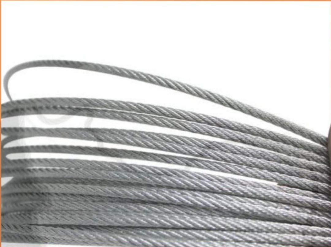
بدلیل استفاده از مغزی الیافی در داخل استرند های سیم بکسل گاورنر میزان استحکام کشش آنها نسبت به ساختار های دیگر سیم بکسل آسانسوری پایینتر می باشد اما از نظر انعطاف بسیار نرمتر و منعطف تر هستند. نرمی و انعطاف بالای سیم بکسل گاورنر سبب گردش آسان آن بر روی گاورنر آسانسور شده و تنش حاصل از فشار لایه ای سبب پارگی مفتول های آن نمی شود.
