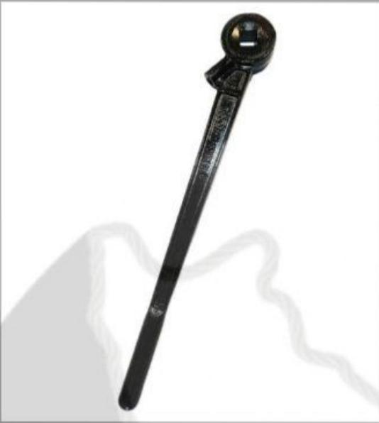
آچار بکس جفجه‌ای به شکل یک دسته به همراه تعدادی سری استوانه‌ای و در اندازه‌های مختلف در دسترس می‌باشد، این سری‌ها به انتهای دسته وصل می‌شوند و برای چرخش اتصالات پیچ و مهره به کار می‌روند
