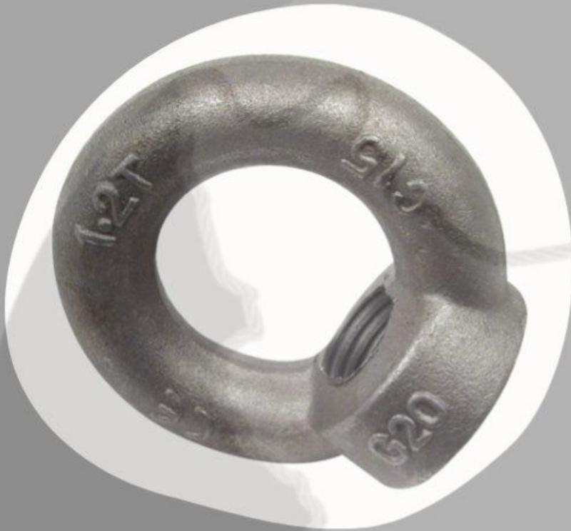
قلاب دینام مادگی در واقع یک مهره دارای چشمی من باشد که در یک طرف بر روی پیچ اتصال قرار گرفته و در طرف دیگر با اتصال با ادوات لیفتینگ مانند اسلینگ های زنجیری و سیم بکسلی لیفت من شود. قلاب دینام مادگی در جنس فولادی با گرید بالا 80 و همچنین از جنس استنلس استیل تولید شده و در سایز های مختلف با قطر داخلی مهره 8 میلیمتر به بالا تولید و عرضه من شود.
