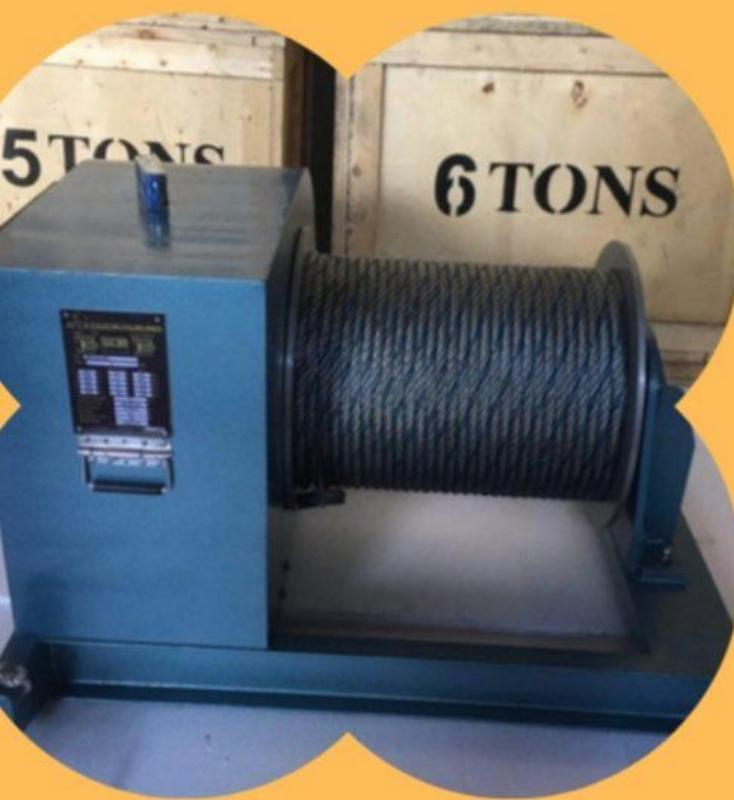
وینچ سیم بکسلی دستگاهی است که در انواع جرثقیل‌ها عملکرد زیادی دارد، این دستگاه با مکانیزم قرقره و سیم عمل می‌کند، حتی میتوان در وینچ‌ها با استفاده از قرقره‌های مرکب امتیاز مکانیکی را بالا برد. وینچ وسیله‌ای است که در کشیدن، جابه‌جایی و حتی بلند کردن اجسام از آن استفاده می‌شود از وینچ بکسلی برقی هم برای جابه‌جایی و بلند کردن اجسام استفاده می‌شود.
